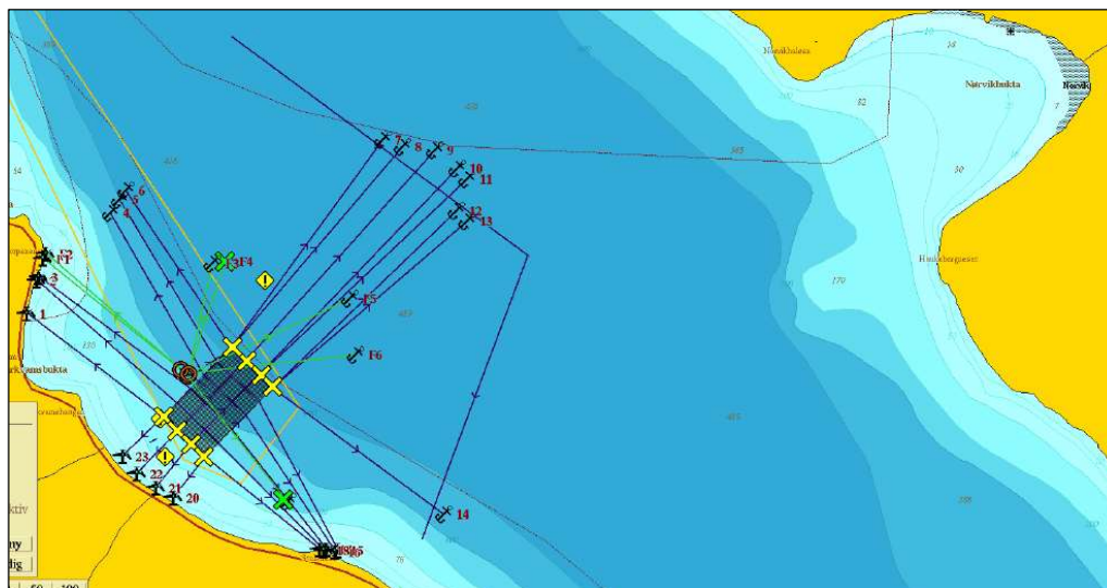
Figur 1 Oversikt over nytt anlegg Vorpeneset. Anleggsutvidelse mot sørøst og nye fortøyninger nr 12, 13 og 20.
